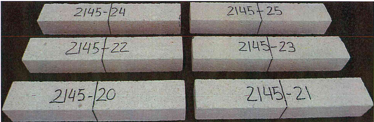
Muestra después de 84 ciclos de hielo-deshielo Sample after 84 freeze-thaw cycles
